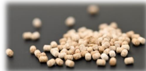
打錠用顆粒：漢方エキス顆粒 錠剤重量：10 mg, 硬度：20N
