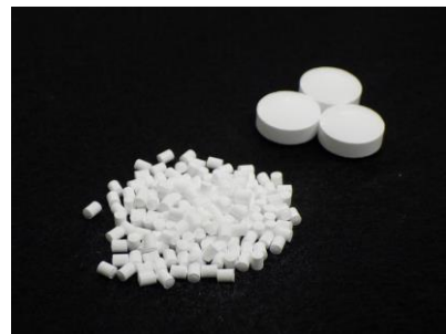
試作したミニタブレット（左）と一般的な錠剤
