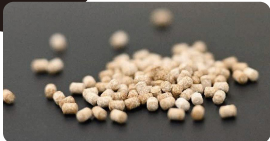
打錠用顆粒：漢方エキス顆粒 錠剤重量：10mg、硬度：20N
