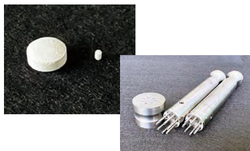
直径2ミリのミニタブレット(左写真)と 開発した高機能ミニタブレット用杵臼(右写真)
